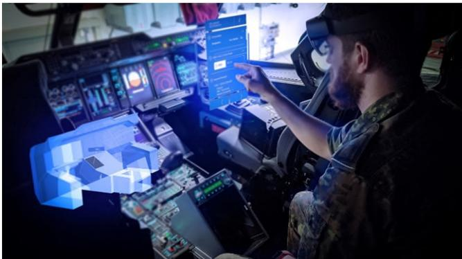
**Abb. 2** Interaktion mit digitalisierter Wartungsvorschrift zum Einbau einer Bildschirm-einheit im Cockpit des Luftfahrzeugs
